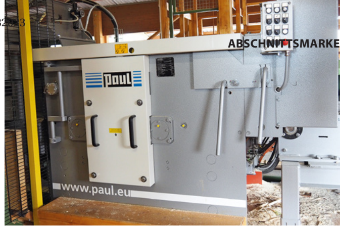
Mehr geht fast nicht mehr: Die KME 3 von Paul hat bei Ferstl unter anderem je eine gesteuerte Null- und bewegliche Sägebüchse sowie drei Trennflansche
