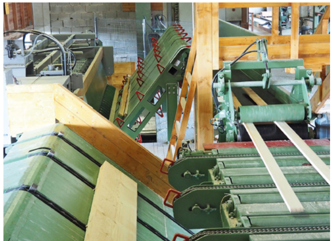
Über ein Förderband von Mayrhofer gelangen die Rückläufer wieder zum Hochförderer für ein erneutes Auftrennen mit der Paul-Anlage
