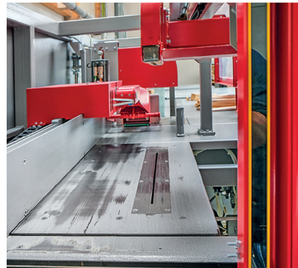
Integriertes Längsschnittaggregat: Dank der zusätzlichen Säge können auch flächige Werkstücke hergestellt werden
