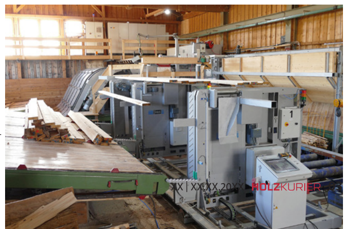
Neuentwicklung der Paul Maschinenfabrik: der mobile Stapelautomat ZSA für flexible Anwendungen
