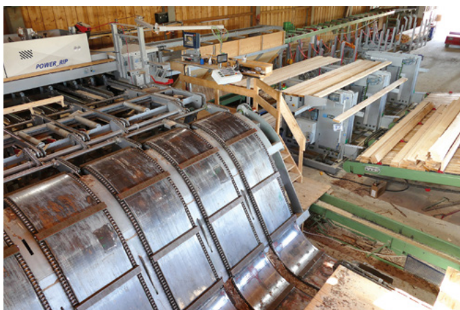
Blick auf die Besäumanlage Power-Rip sowie den nachfolgenden, mobilen Stapler des Typs ZSA
