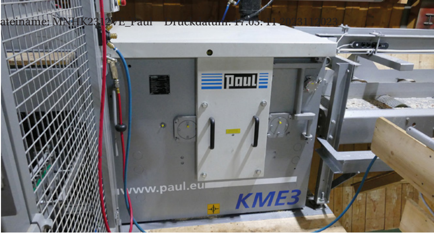
Die Paul Maschinenfabrik lieferte an das Sägewerk Hainz eine Doppelbesäumkreissäge des Typs KME3 mit vier verstellbaren Sägebüchsen sowie einem 90 kW starken Motor
