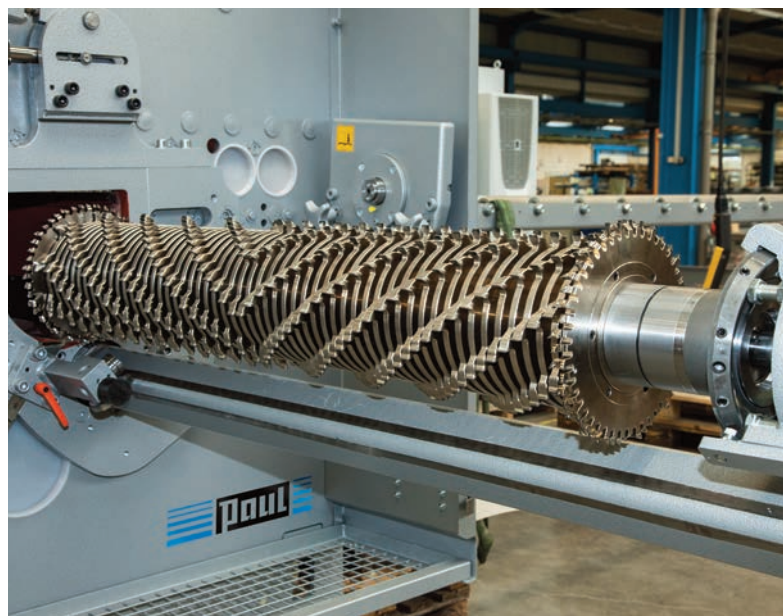
► Die Mehrblattsäge mit ausgezogener Sägewelle, auf der die 56 Nutwerkzeuge und zwei Randzerspaner montiert sind.
