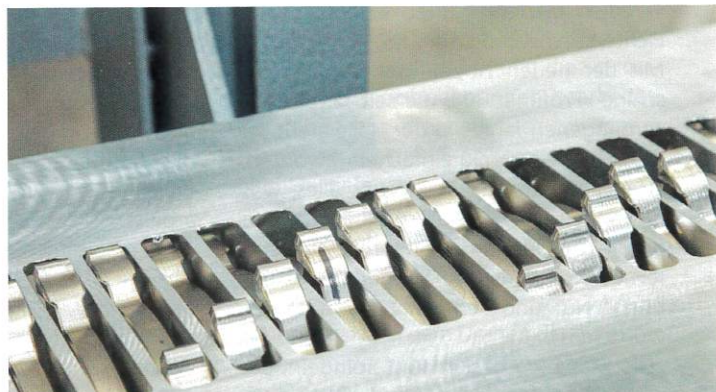
Die Auflage an den Nutwerkzeugen sorgt für eine sichere Führung der Werkstücke.
