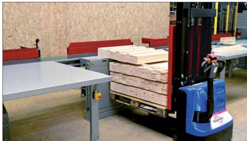
Das „Stack & Move“-System „Sam“ besteht aus einem speziellen Abschieber, einem Klappstisch und einem Elektrostapler.
