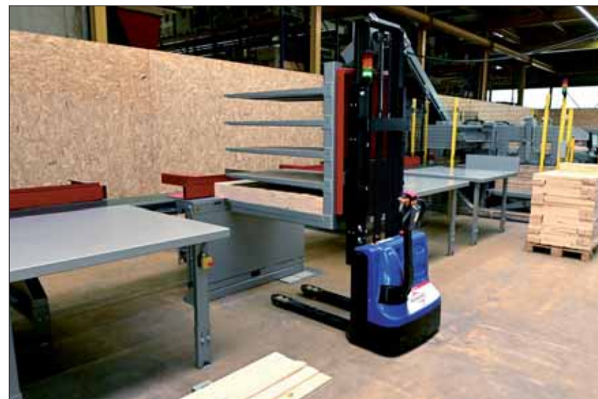
Mit dem optionalen „Sam“-Regal wird der Elektrostapler zum vollautomatischen Stapelsystem.
