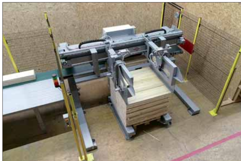
Die vollautomatische Stapelmaschine „Fast“ stellt sich selbst auf die zu stapelnde Länge ein und legt auch Stapelleisten.
