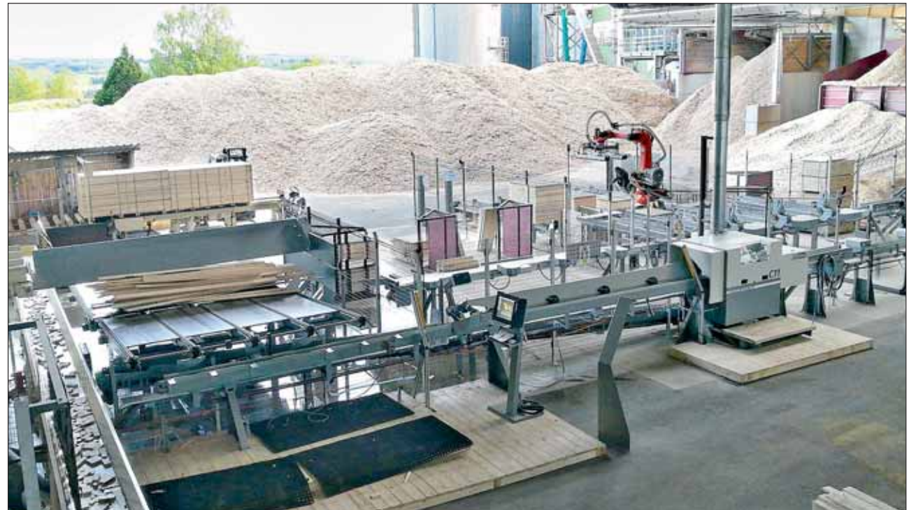
Übersicht über die Paul-Kappanlage: links der Zulauf aussortierter Bretter von der Kalfass-Sortieranlage, davor die Station zur manuellen Fehlermarkierung, rechts die „C11“-Kappanlage, dahinter der Abstapel-Roboter mit vier Pufferplätzen. – Die an einem Freitagmittag im Hintergrund sich auftürmenden Hackschnitzelhaufen stellen die Pelletproduktion während des Stillstands im Sägewerk am bevorstehenden Wochenende sicher. Foto: Paul Maschinenfabrik
