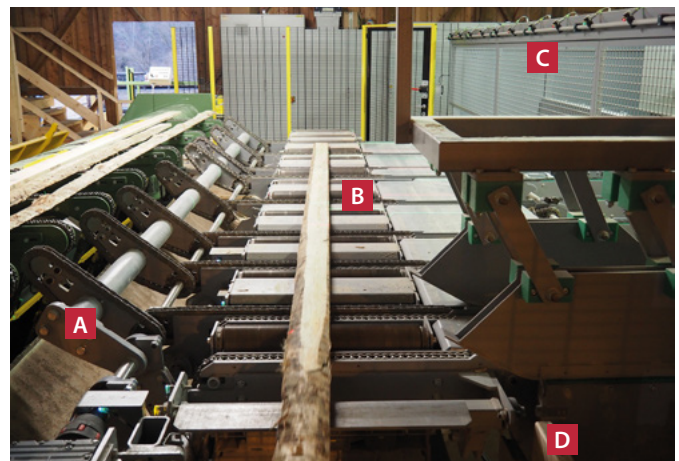
Flexibler Paul-Zuführtisch: Klappe zum Auswerfen beziehungsweise Wenden (A), Trennkreissäge (B), Laser in 50 cm-Schritten (C), Schwartenkappsäge (D)
