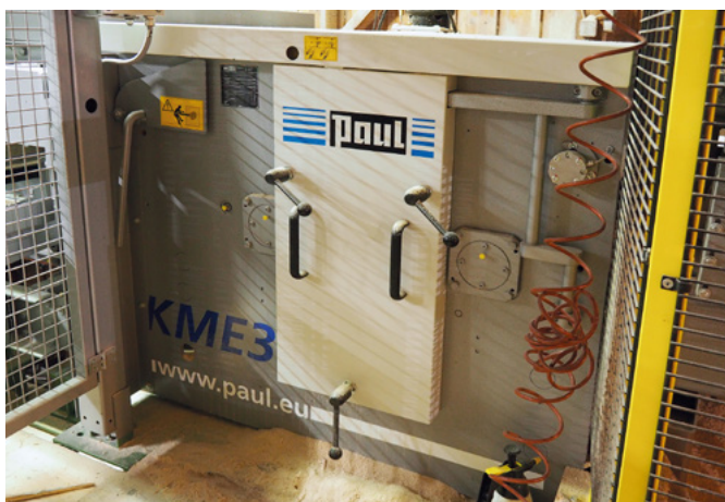
Die KME3 von Paul punktet mit je zwei Trennflanschen und beweglichen Sägebühnen sowie einer Schnitthöhe bis 125 mm
