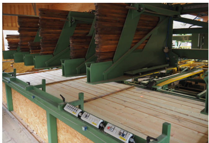
Mit der Stapelanlage mit sieben Leistenmagazinen lassen sich bis zu 1,5 m breite Pakete bilden
