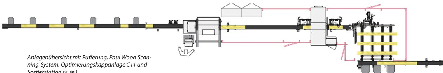
Anlagenübersicht mit Pufferung, Paul Wood Scanning-System, Optimierungskapplanlage C11 und Sortierstation (v. re.)
