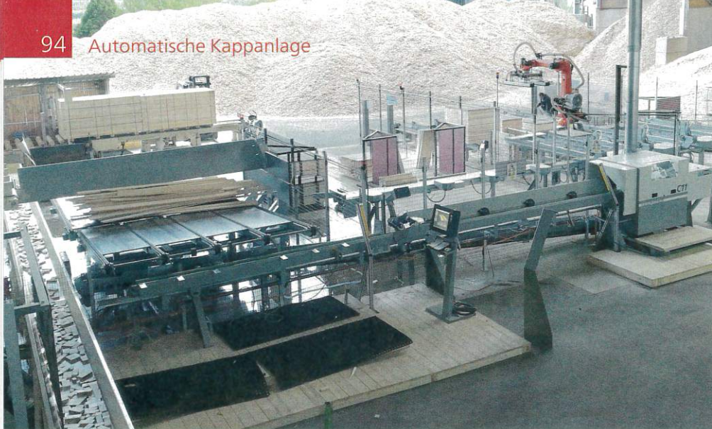
Die neue Anlage zur Optimierung des Werkstoffs Holz beinhaltet eine Kappsäge (vorn) und einen Stapelroboter (hinten). Bilder: Paul Maschinenfabrik
