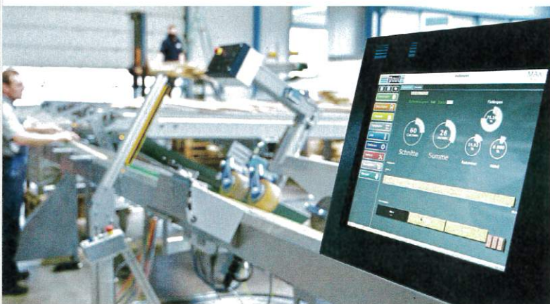
CNC-Steuerung der Kappsäge: Das gesamte System ist über ein Terminal komfortabel bedienbar.
