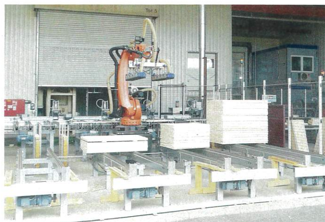
Stapelroboter mit Pufferplätzen für fertige Holzstapel.
