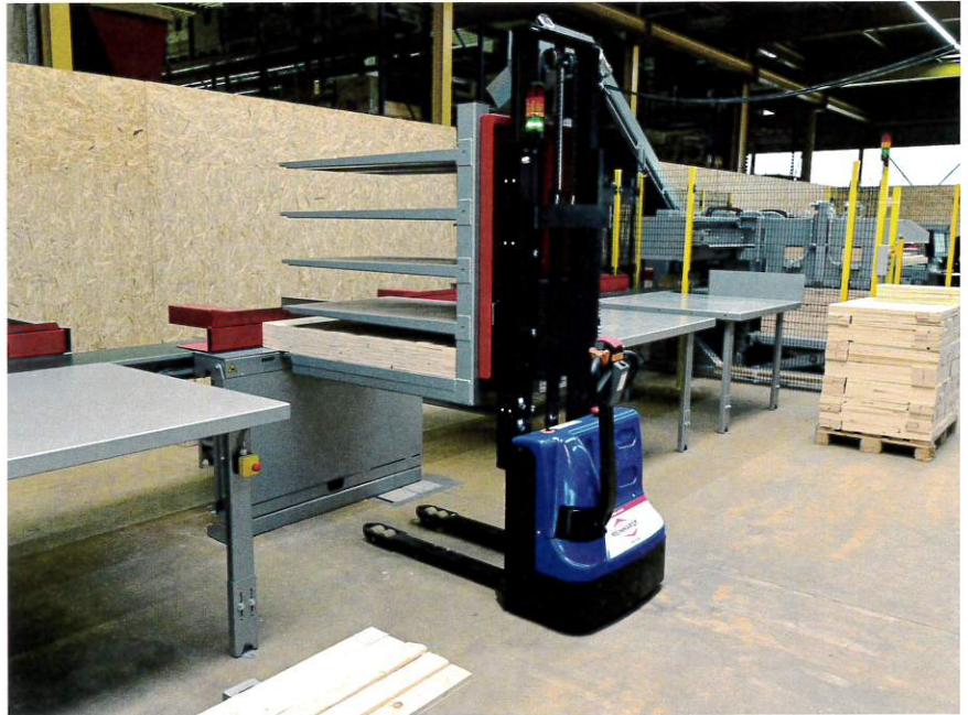
Mit dem optionalen „SAM“-Regal wird der Elektrostacker zum vollautomatischen Stapelsystem.
