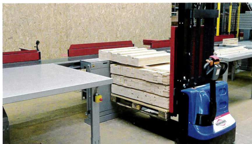
Das Stack&Move-System „SAM“ besteht aus einem speziellen Abschieber, einem Klapptisch und einem Elektrostapler.
