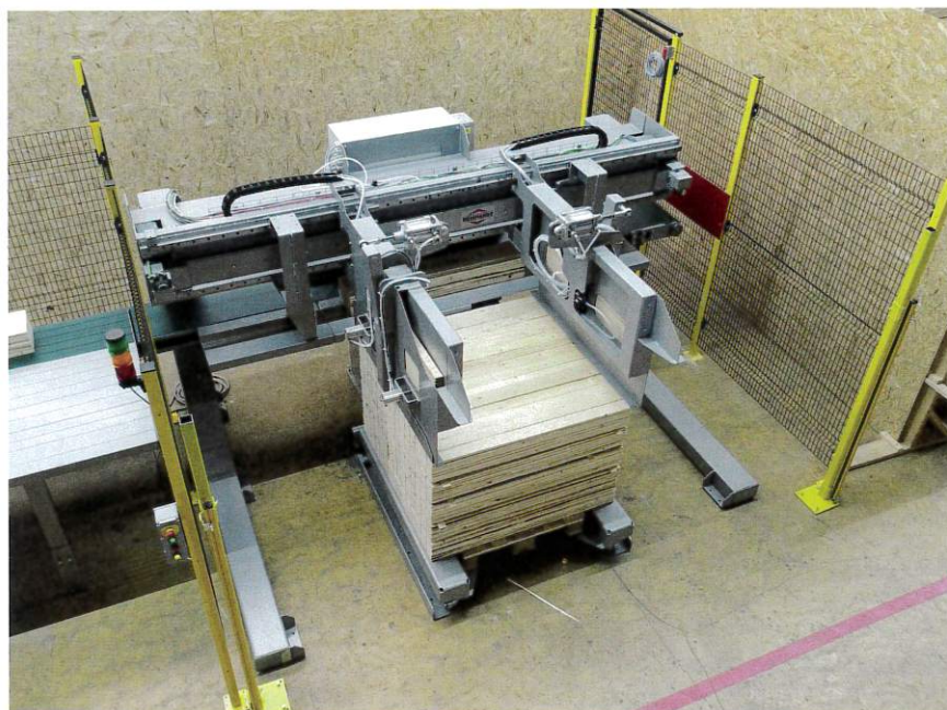
Die vollautomatische Stapelmaschine „FAST“ stellt sich selbst auf die zu stapelnde Länge ein und legt auch Stapelleisten.
