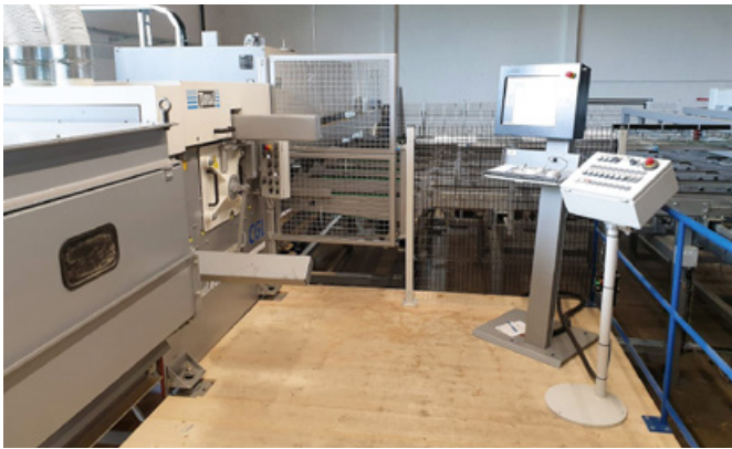
Die Paul Maschinenfabrik lieferte an Möbelwerke A. Decker eine computergesteuerte Auftrennkreissäge des Typs CGL...
