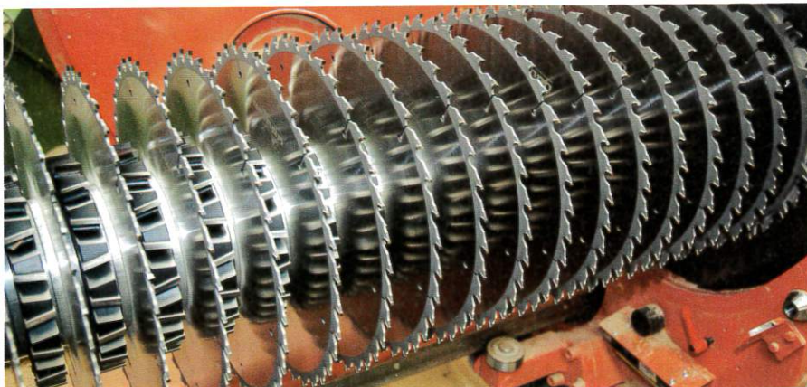
▲ Auf der Sägewelle sind 20 Sägeblätter und dazwischen die Nutfräser aufgespannt.
