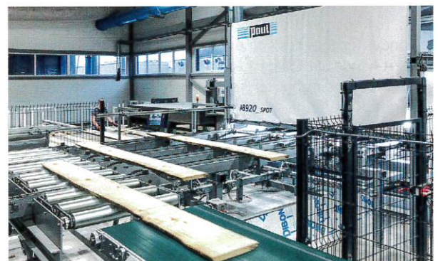
Optimierungsergebnis, bei dem das Werkstück zur Steigerung der Ausbeute in zwei verschiedene Richtungen aufgetrennt wird. Dies wird durch einen zweiten Durchgang ermöglicht.
