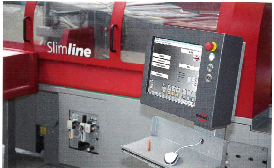
Schieberkappsäge »SlimLine Formatic« mit zusätzlichem Sägeaggregat zum Auftrennen von geschlossenen Decks (Reinhardt).
