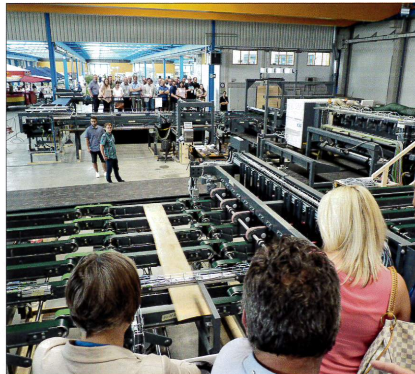
„Gwiazdą“ targów, zorganizowanych przez firmę Paul, była kompleksowa linia cięcia do produkcji grubych fornirów. Zdjęcia: Bolz, Frenkel
