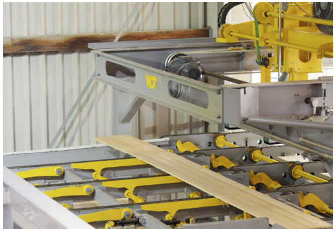
Die Lamellen in fallenden Breiten werden von der WDT-Steuerung zu Lagen gebildet...
