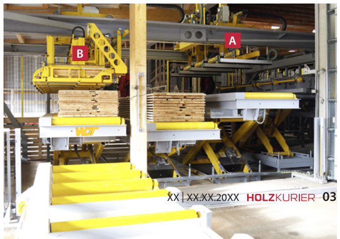
Der Vakuumheber (A) hebt die Lagen auf einen der zugewiesenen Plätze, von links kommen die Stapelleisten (B)
