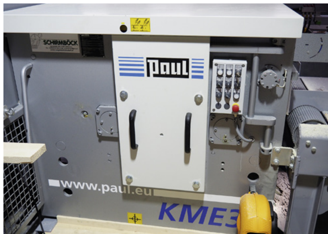
Die Besäumkreissäge KME3 von Paul in Linksausführung mit 800 mm Durchgangsbreite und einer maximalen Schnitthöhe von 125 mm
