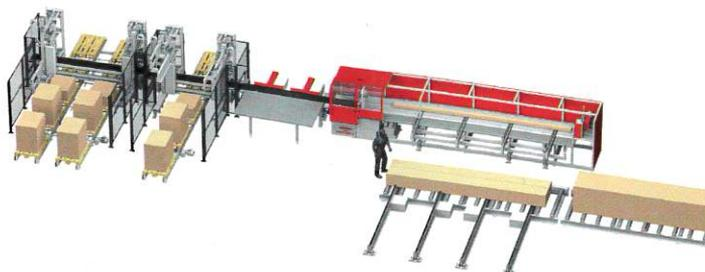
Reinhardt-»Quickstop«: Kappsäge mit automatischem Schiebesystem, Zangengreifer und Stapelanlage sind aufeinander abgestimmt.
