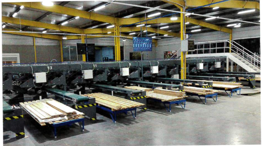
Bei der kundenorientierten Zuschnittanlage zur Herstellung von Starkfurnieren werden die fertigen Starkfurnierlamellen auf Paletten gestapelt. Bilder: Paul
