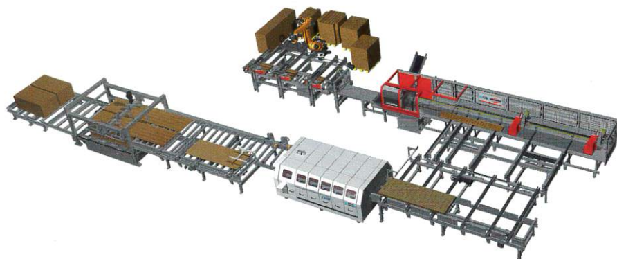
Vollautomatische Zuschnittanlage von Paul mit Beschickung, flexibler Mehrblattkreissäge, Schieberkapp- und Sortierroboter.
