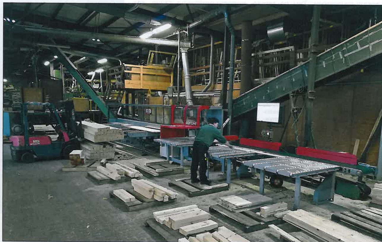
Общий вид торцовочной установки с оптимизацией Slim Line 225 в компании Aalbers Wilk Emballage. Снимки: Paul
