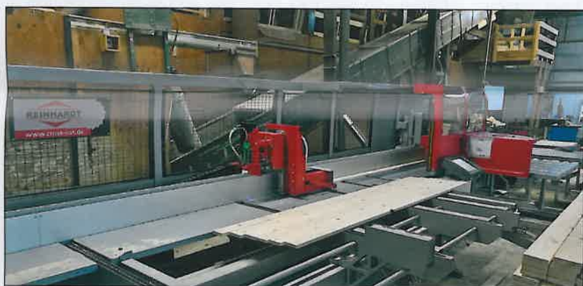
Во время обратного хода позиционирующий шибер определяет длину, а также отмеченные дефекты и толкает заготовку через торцовочную станцию.
