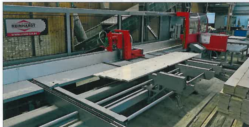
Podczas przesuwu powrotnego popychacz rejestruje długość elementu oraz oznakowane wady i przesuwa obrabiany element przez stację przerynarki.
