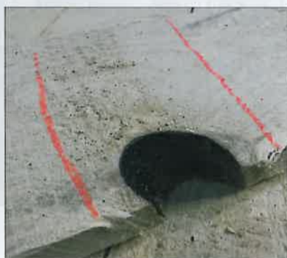
Wady przedmiotu obrabianego zaznaczane są kredą fluorescencyjną.
