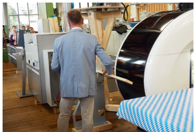
Die Daten aus dem Scanner gelangen online zur Kappanlage – Manfred Buck von Paul „füttert“ die C11 mit dem Werkstück
