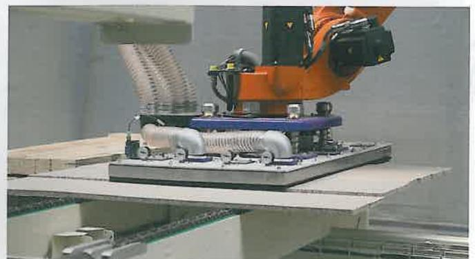
▲ Der Roboterarm hält die Werkstücke sicher mit einem Vakuumgreifsystem
