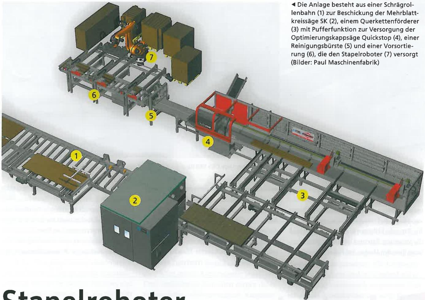
◀ Die Anlage besteht aus einer Schrägrollebahn (1) zur Beschickung der Mehrblattkreissäge SK (2), einem Querkettenförderer (3) mit Pufferfunktion zur Versorgung der Optimierungskappsäge Quickstop (4), einer Reinigungsbürste (5) und einer Vorsortierung (6), die den Stapelroboter (7) versorgt (Bilder: Paul Maschinenfabrik)
