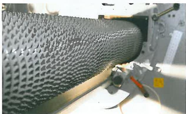
**Die ausgezogene Sägewelle einer Mehrblattkreissäge kann mit bis zu 98 fest aufgespannten Sägeblättern bestückt werden.**
