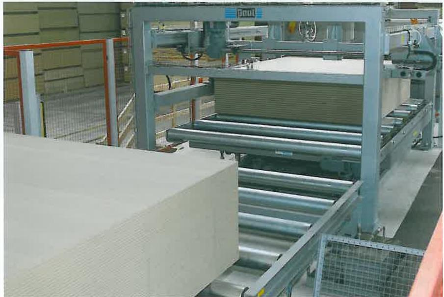
**Automatische Plattenbeschickung bei der Leistenproduktion, der nächste Stapel liegt schon zur Beschickung bereit.**
