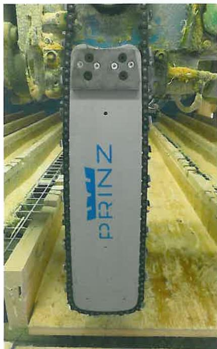
*PRINZ entwickelt und produziert Schneidgarituren für Portal- und Abbundanlagen zum Bearbeiten von Holzbaukonstruktionen.*
