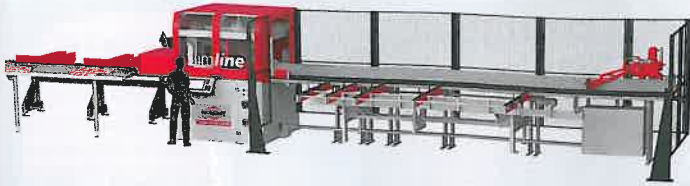
Kappanlage „SlimLine“ mit Schiebesystem (Reinhardt)
