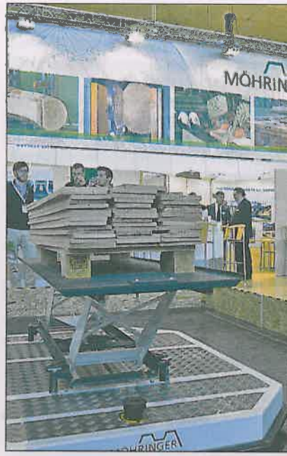
„M.A.T.S.“ von Möhringer dreht selbstständig seine Runden und steuert die vorher festgelegten Stationen an, gesteuert über Induktionslinien.
