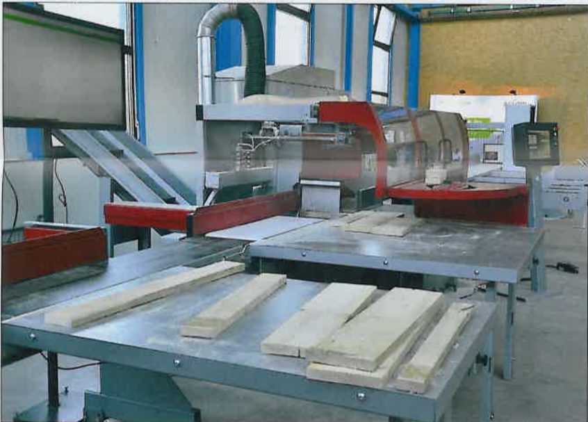
„Slimline“ – универсал среди торцовочных пил, она работает в полностью автоматическом режиме, включая в себя и обрезную пилу.
