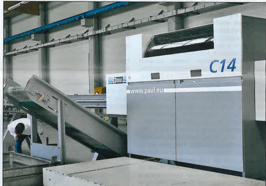
На торцовочной установке C14_MKL выполняется вырезание дефектов древесины на обрезных досках.
