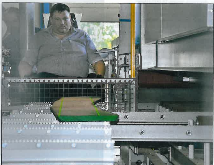
Ход раскроя для пильных полотен указывают лазерные линии.
