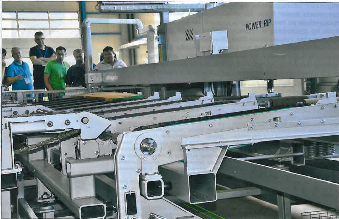
Изюминкой „Expo“ компаний Paul и Reinhardt стала установка для раскроя древесины лиственных пород. Сразу после ленточной пилы дубовые доски автоматически перемещаются к круглопильному кромкообрезному станку.
