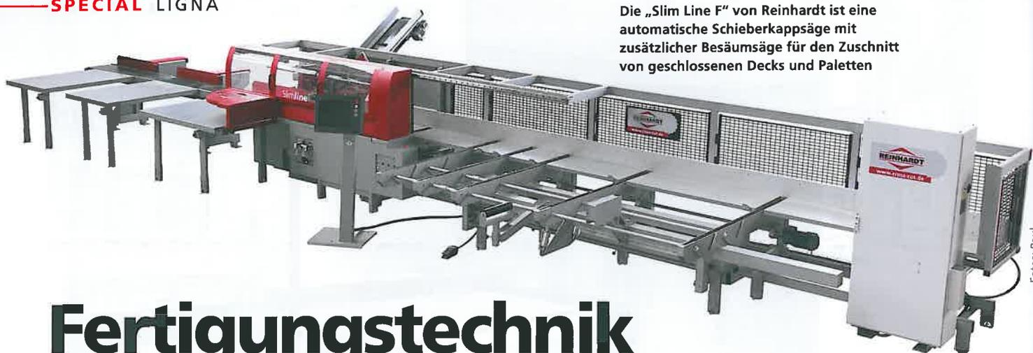
Die „Slim Line F“ von Reinhardt ist eine automatische Schieberkappsäge mit zusätzlicher Besäumsäge für den Zuschnitt von geschlossenen Decks und Paletten
