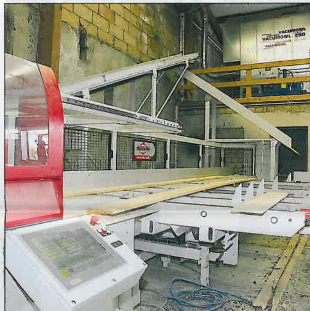
Prosta obsługa sterownika CNC z ekranem dotykowym.
