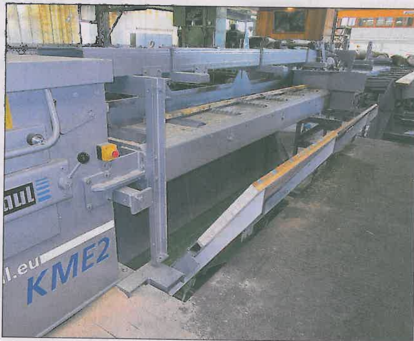
Doppelsäumer „KME 2“ mit automatischem Spreißelabscheider
