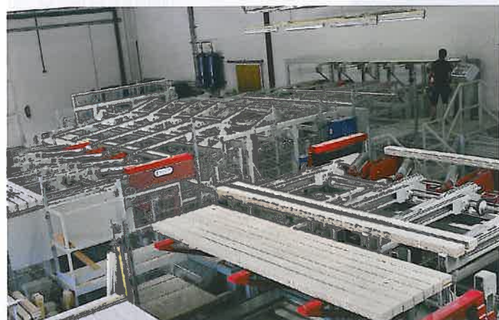
Hobellinie mit zwei Stapelplätzen und Bündelautomaten (Oesterle)
